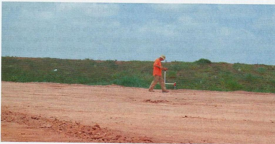
Figura 3 – Técnico realizando as medições em campo referentes ao *Soil Survey*
