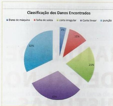
Figura 5 – Classificação e percentual de ocorrência dos principais danos encontrados na geomembrana das áreas inspecionadas pelo Soil Survey
