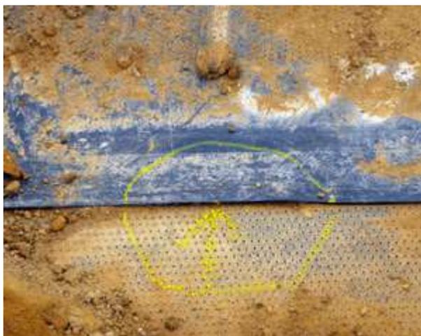
Figura 8. Falha identificada na solda da emenda entre as geomembranas.
